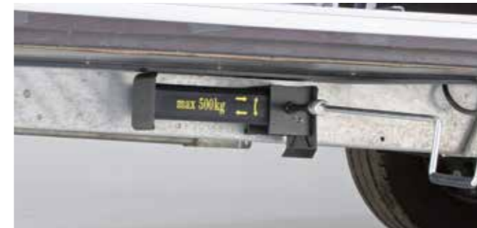
Kurbel auf Sechskant setzen und Kurbeln
