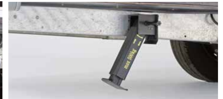
Kurbeln bis Stütze senkrechte Position hat
