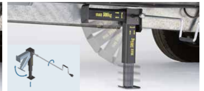
Kurbeln bis der Standfuß auf dem Boden steht.
