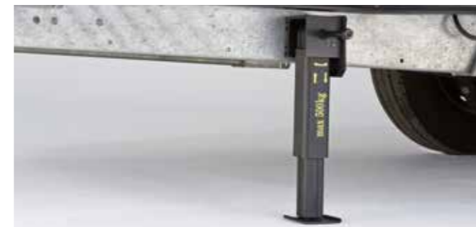
Stütze fährt automatisch teleskopartig aus.
